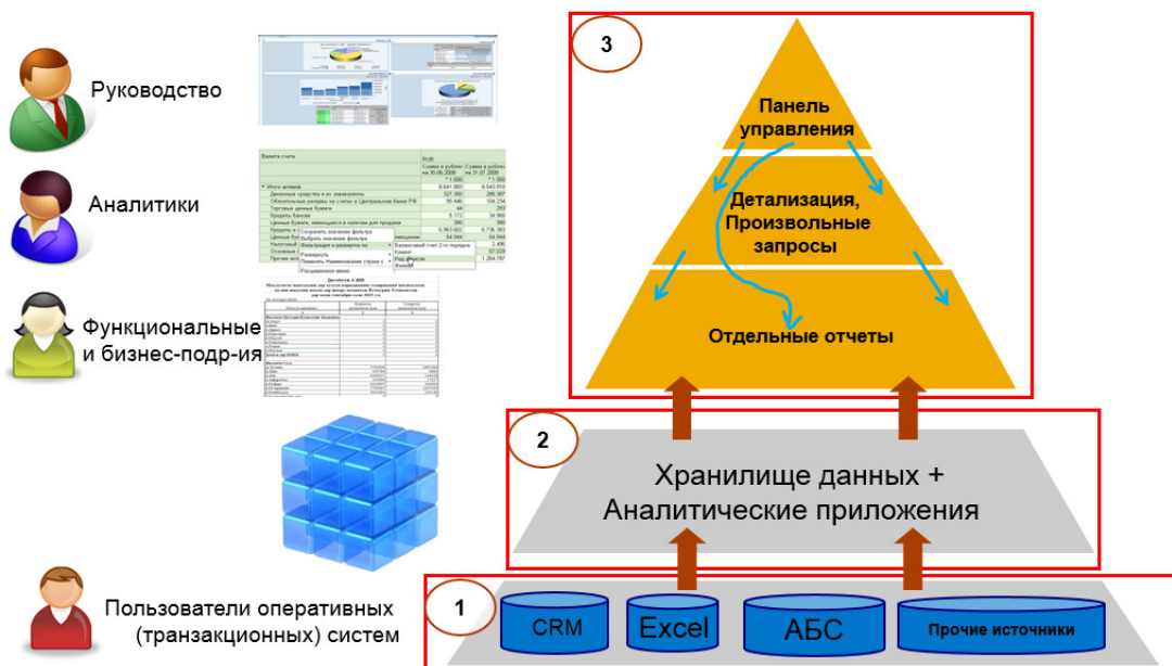
Рисунок 11. Внутренняя архитектура СУО на основе ПУ («3»), обеспечивающая необходимую гибкость для ролевого использования информации (для групп пользователей) и для поиска информации при принятии решений (логика поиска условно показана синими стрелками)
